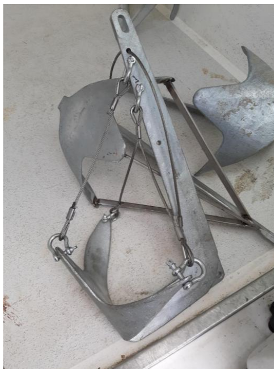
Figure 4-6 : Exemple de modification de l'ancre Bruce avec trois câbles métalliques pour limiter le risque de croche [Rozemeijer et al. , 2022]
