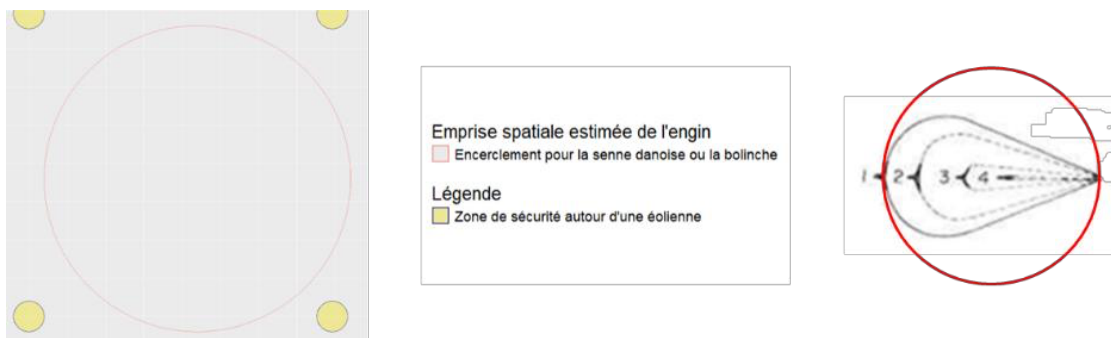
Figure 2-8 - Représentation en vue de dessus de l'emprise spatiale de l'encerclement pour les sennes et bolinches. Adapté de [FAO, 1988]
